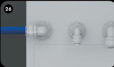
Свободный конец синей трубки, ранее подключенной к шаровому вентилю-адаптеру, подключите к фитингу насосного блока (Исходная вода) согласно рисунку.
