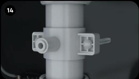
Наклейте прокладку на внутреннюю сторону скобы дренажного хомута с фитингом. Закрепите скобу с прокладкой таким образом, чтобы отверстие в сливной трубе совпало с отверстием хомута.
