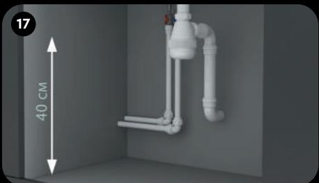
Выберите место для фильтра на расстоянии не более 1 метра до точки подключения воды и на высоте более 40 см от пола.
