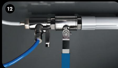
12 Открутите от крана гайку для трубы. Наденьте гайку на синюю трубку. С усилием натяните трубку на штуцер шарового вентиля-адаптера до упора и закрутите гайку.
