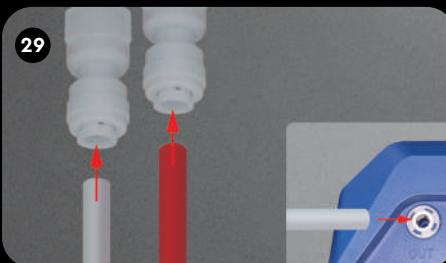
Подключите систему к крану чистой воды. Для этого в комплекте идут белая и красная трубы. Один конец белой трубы вставьте в фитинг, установленный на длинный резьбовой хвостовик крана (минерализованная вода). Подключите к блоку фильтра, где написано OUT.
